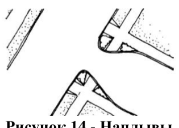
Рисунок 14 - Наплывы линии бортового камня в зоне перехода
